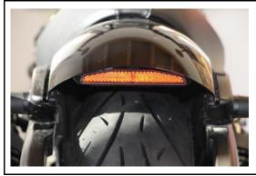
Den Halter anschließend mittig und hinten bündig am Fender ausrichten und ebenfalls <u>stark</u> anpressen.
