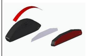
Achtung: Bei der Herstellung des Halters wird Schmiermittel verwendet, daher sind die Klebeflächen am Halter gründlich mit Bremsenreiniger zu reinigen und zu entfetten.
